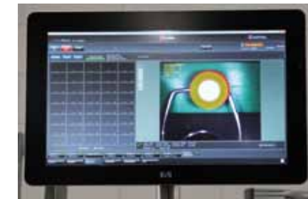
21.5" Touchscreen mit selbsterklärender Bedienungsführung, unbegrenzter Sortenvorwahl, Vision- und Traceability-Funktion
