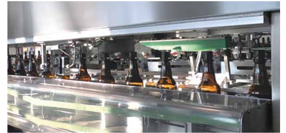
Die pat. KS berührungslose Bügelanhebung sowie modernste CCD-/CMOS-Kameras und Hochleistungs-LED-Beleuchtung sorgen für sichere Fehlererkennung und Darstellung auf dem gemeinsamen Touchscreen mit integrierter, selbsterklärender Bedienfunktion.
