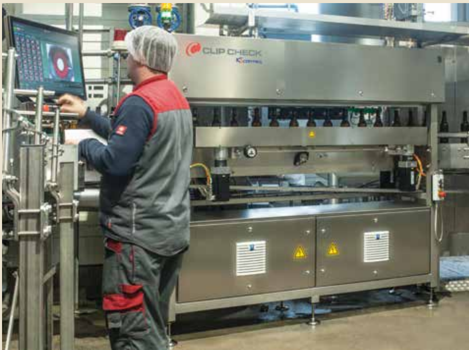
KS CLIP CHECK Bügelverschluss-Vollinspektor in der Abfülllinie
